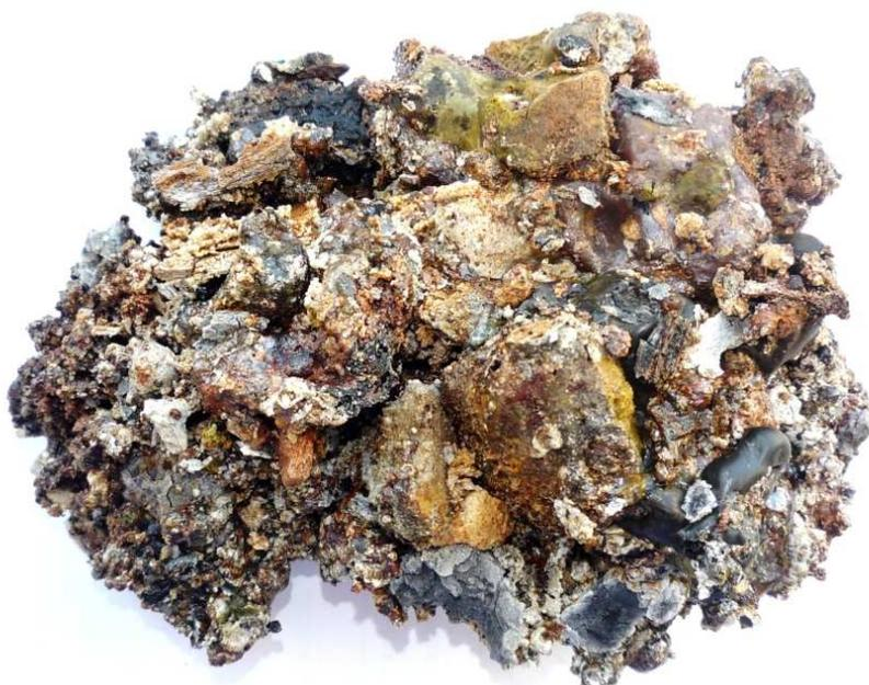
Рис. 1. Конгломерат частично оплавленных минеральных частиц
