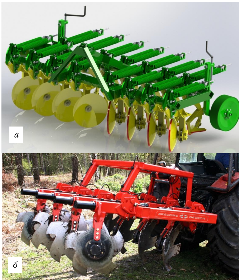
Рис. 3. Лесохозяйственные орудия для проведения агротехнических уходов а – культиватор КРТ – 3; б – борона TIMBERDISC
