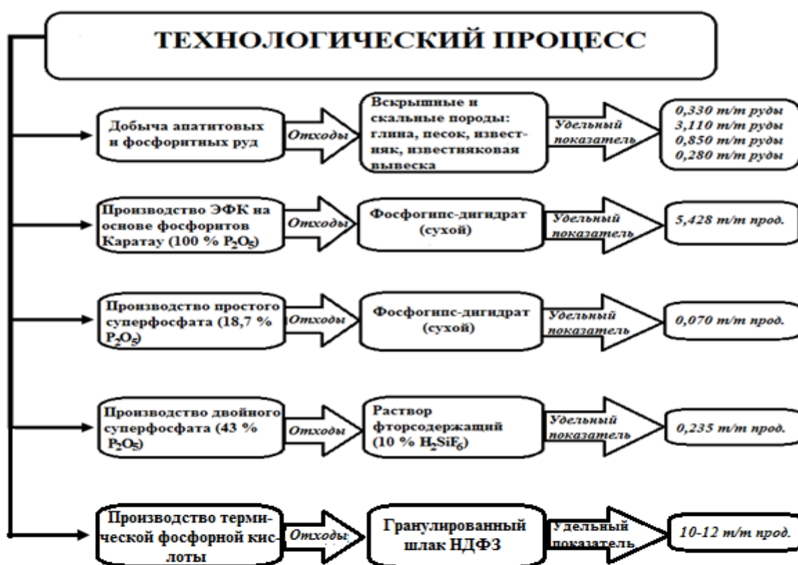
Рис. 1. Виды и объемы отходов, получаемых при производстве фосфорсодержащих веществ.
