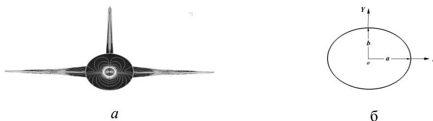
Рис. 2. Компоновка моноплан \mu = b/a = 0.75 : а - вид спереди, б - контур поперечного сечения корпуса
