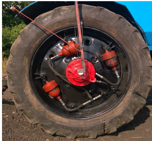
Рис. 6. Газогидравлический привод на ведущих колесах
