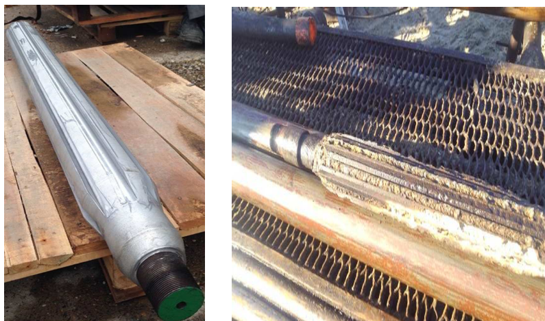
Рис. 3. Протекторная защита марки сплава Ац5М5 до и после испытаний
