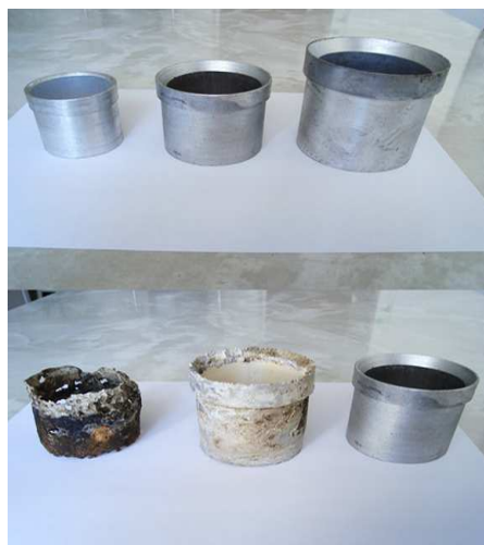
Рис. 5. Протекторы ВПК до и после защиты НКТ от коррозии
