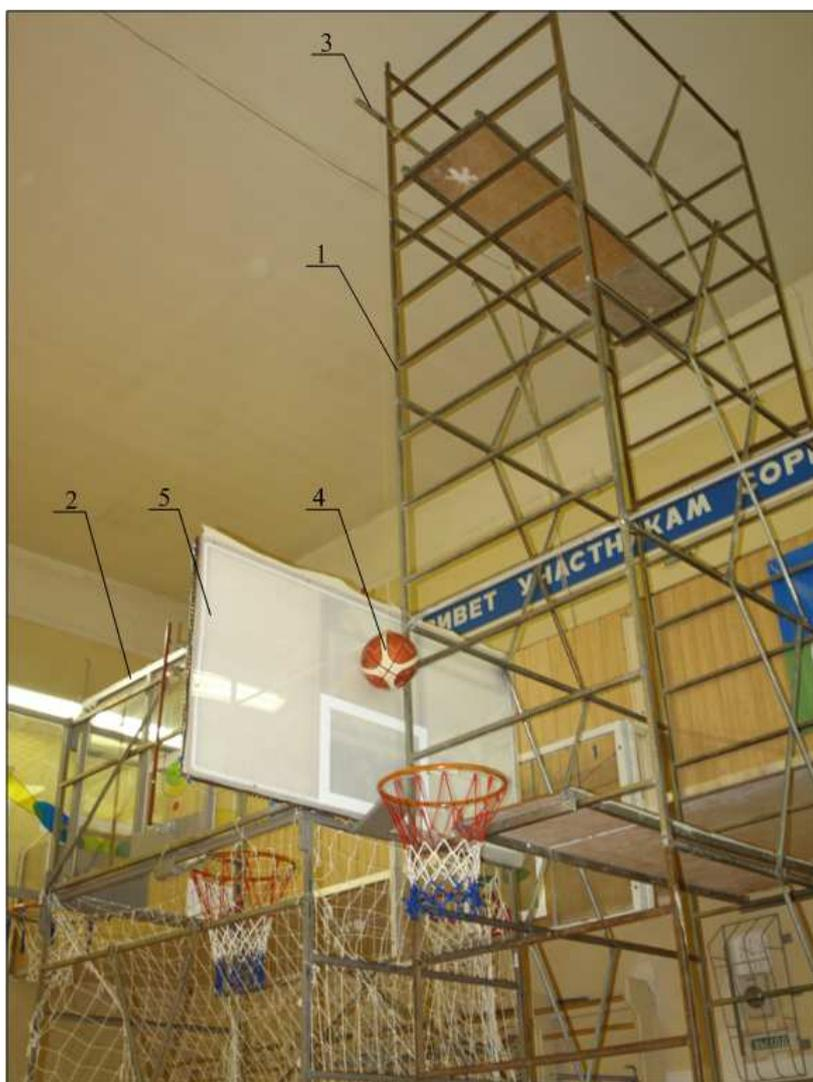
Рис. 4. Экспериментальная установка определения коэффициента восстановления: 1 - вышка, 2 - передвижной бросковый модуль, 3 - «удочка», 4 - баскетбольный мяч № 7, 5 - сенсорный щит.
