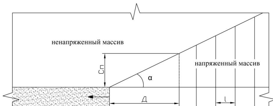
Рис. 2. Модель разрушения массива вдоль заряда
