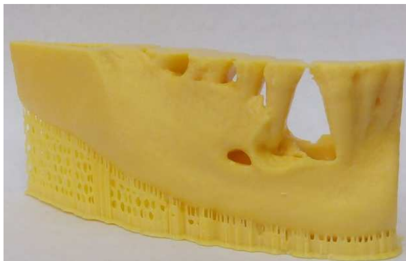
Рис.4. Экспериментальный образец фрагмента нижней челюсти из фотополимерного материала SI500
