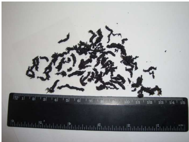
Рис. 1. Деформированные и измельченные гранулы ПВХ-пластиката
