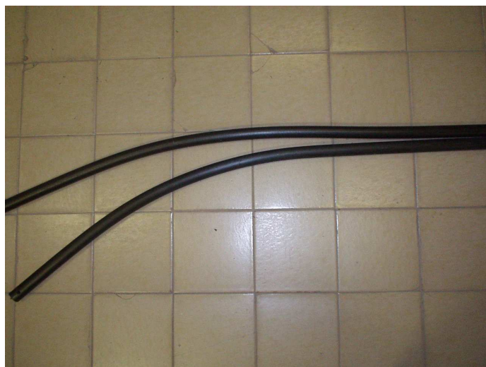
Рис. 3. Деформация трубы после снятия нагрузки
