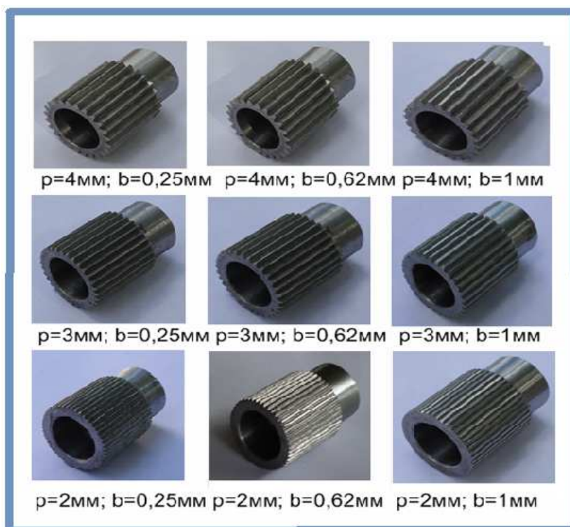
Рис.2. Параметры сменных рифленых валков
