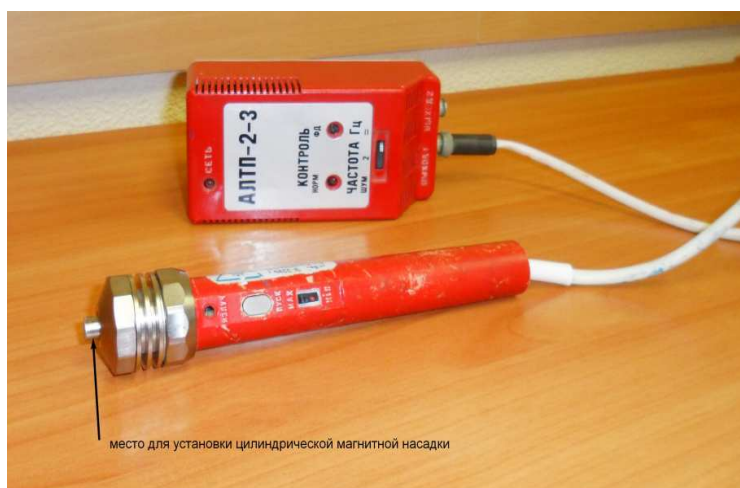
Рис 1. Аппарат лазерной терапии АЛТП-2-3 для магнитолазерной терапии с использованием шумовой модуляции лазерного излучения
