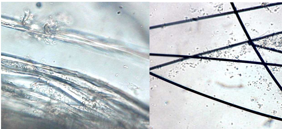
Рис. 2. Микробная колонизация хлопчатобумажных (А) и углеродных (Б) нитей.
