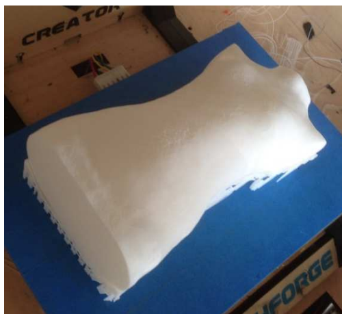
Рис. 4. Напечатанная 3D-модель манекена индивидуальной фигуры
