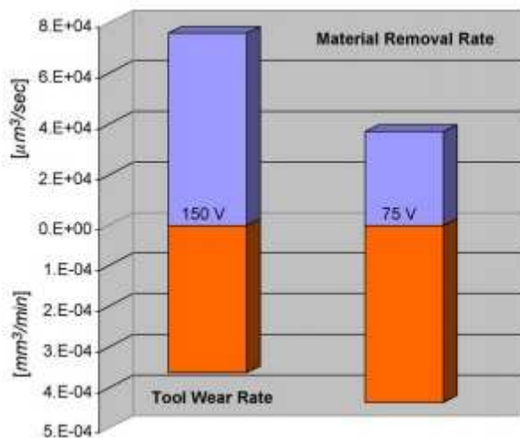
Рис. 2. Скорость удаления материала и износ инструмента в зависимости от напряжения. Увеличение входного тока увеличивает скорость съема материала и скорость изнашивания материала (рис. 3).
