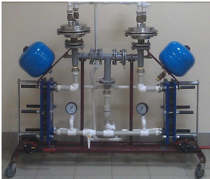
Рис.2. Общий вид макетного образца теплового пункта с корректирующим контуром импульсной циркуляции
