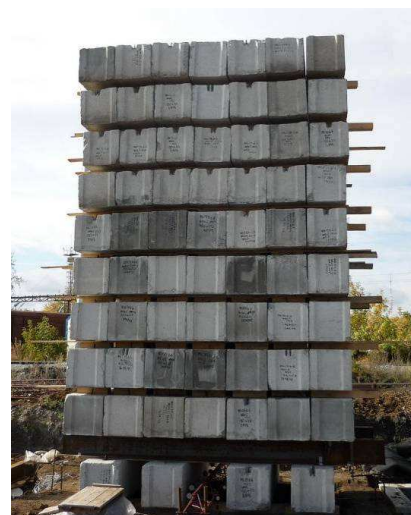
Рис. 1. Оснастка грунтового основания глубинными месдозами и марками
