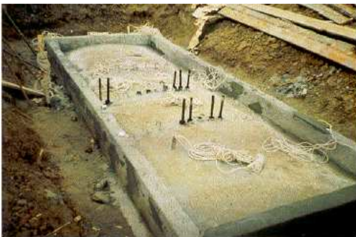
Рис. 1. Оснастка грунтового основания глубинными месдозами и марками
