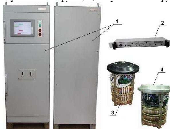
Рис. 5. Макетный образец системы электропитания телеуправляемого необитаемого подводного аппарата
