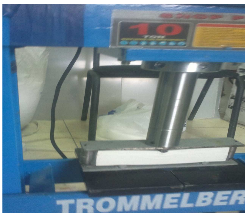
Рис. 1. Испытание образцов на растяжение при изгибе
