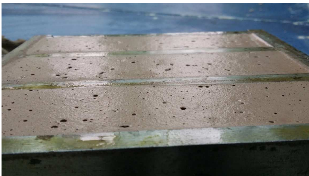
Рис.1. Распределение пенокерамической массы в форме после укладки
