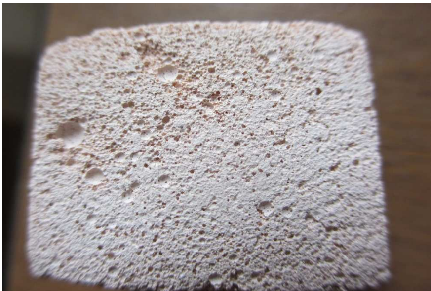
Рис. 3. Структура поверхности среза обожжённого пенокерамического образца
