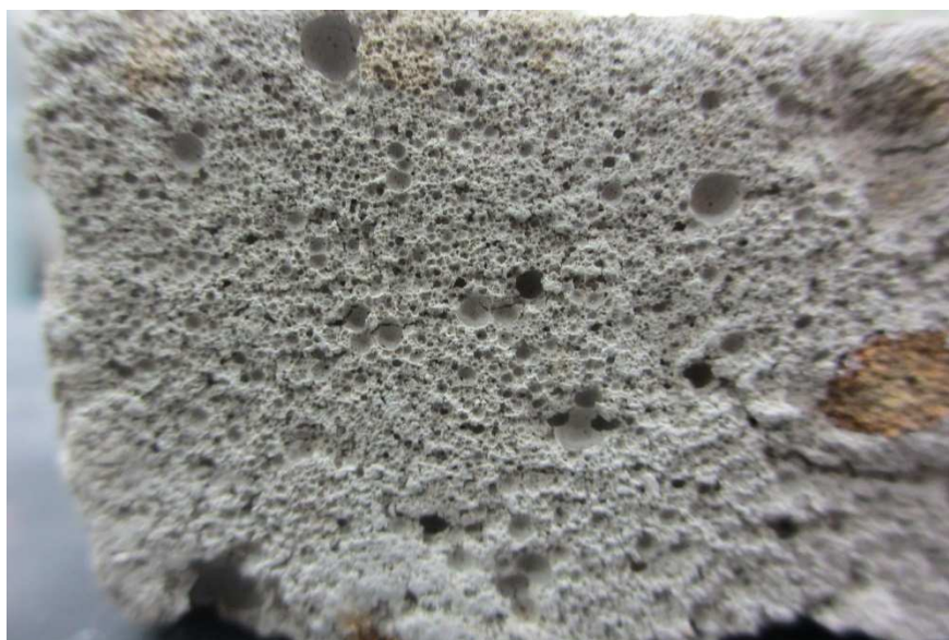
Рис. 2. Структура поверхности среза высушенного пенокерамического сырца
