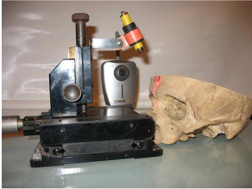
Рис. 2. Анатомо-топографический лазерный видеоизмеритель
