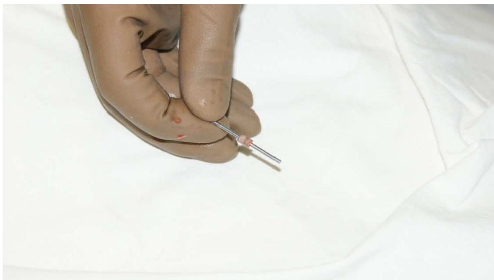
Рис. 3. Внутрикостная втулка на основе нетканого титанового материала со сквозной пористостью, модифицированная аутологичной костной тканью
