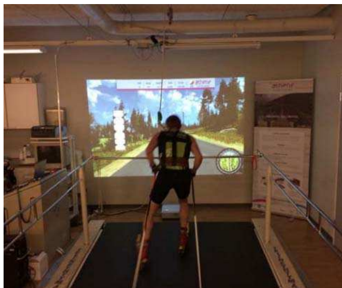
Рис. 4. Тестирование на лыжероллерном тредмиле с системой Athene (Nurkkala V., Kalermo J., Jarvilehto T., 2014)
