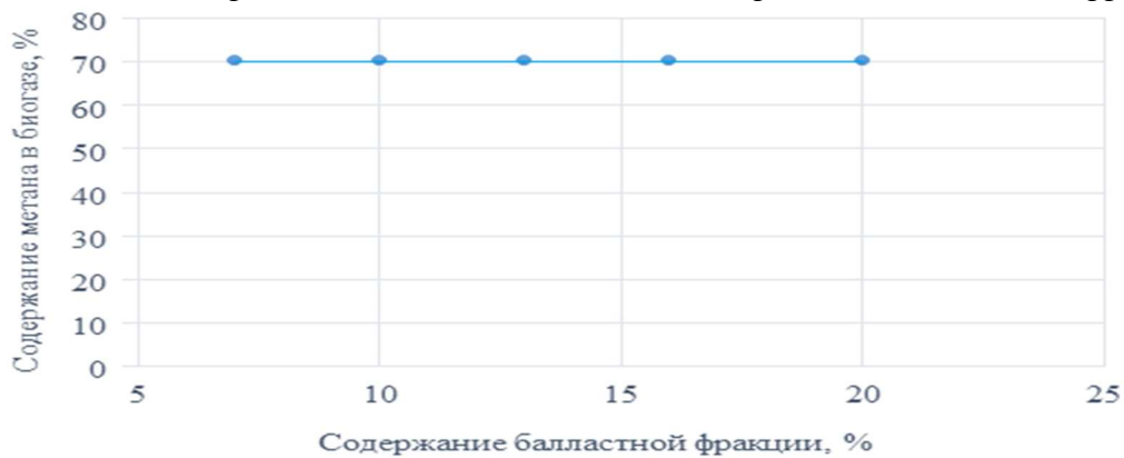
в) зависимость содержания метана в биогазе от содержания компостной фракции
