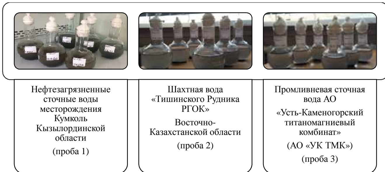
Рис. 1. Эксперимент по очистке сточных вод с применением тауриткарбонатного шунгита
