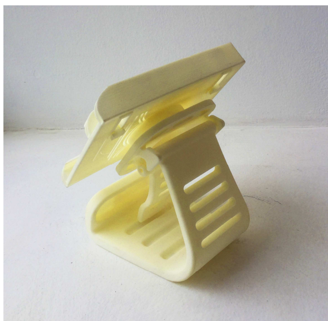
Рис. 5. Фото изготовленной на 3D-принтере (технология SLS) подставки для сотового телефона по трехмерной модели, разработанной в программе SolidEdge
