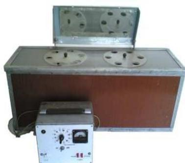
*Рис. 2. «Челночная» камера для выработки и проверки РАИ*
