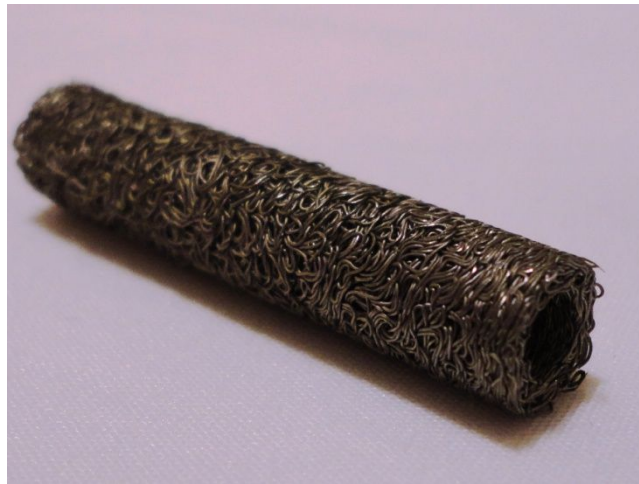
Рис. 2. Втулка из спиральной титановой проволоки диаметром 100 мкм со сквозной пористостью 70%
