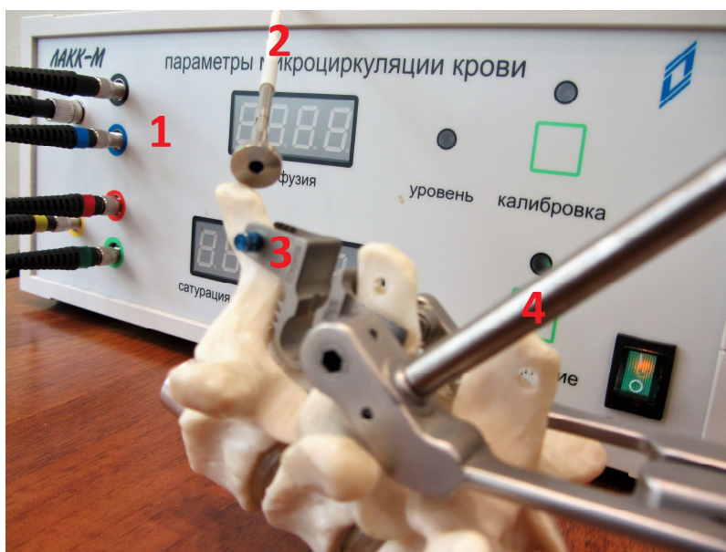
Рис. 1. Схема регистрации сатурации в остистом отростке при имплантации динамического фиксатора. 1 – ЛДФ (лазерный доплеровский флуометр); 2 – световод; 3 – межостистый фиксатор; 4 – динамометрический ключ
