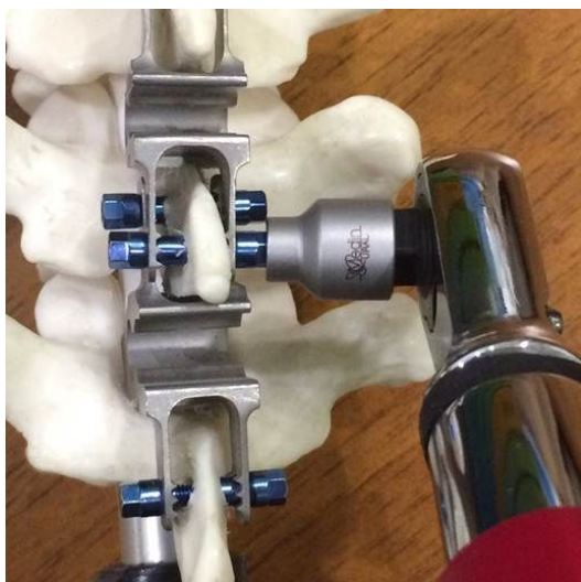
Рис. 2. Фиксации протезирующего динамического устройства контролировались динамометрическим ключом с цифровой индикацией момента силы при закреплении межостистого фиксатора
