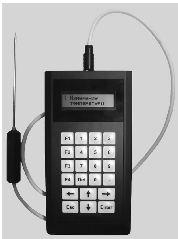
Рис. 1. Внешний вид игольчатого электронного термоизмерителя
