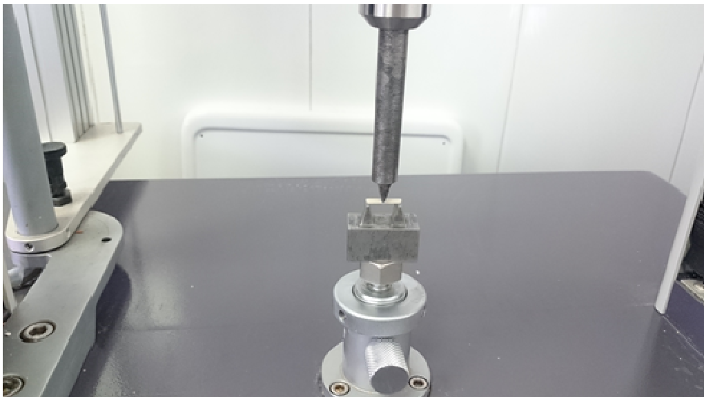
Рис. 2. Проведение испытания образцов при помощи универсальной испытательной машины GOTECH AI 7000S
