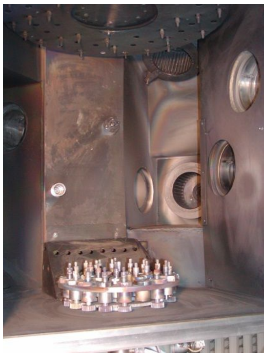
Рис. 6. Установки для проведения напыления алмазоподобных покрытий и проведения 3-D моделирования
