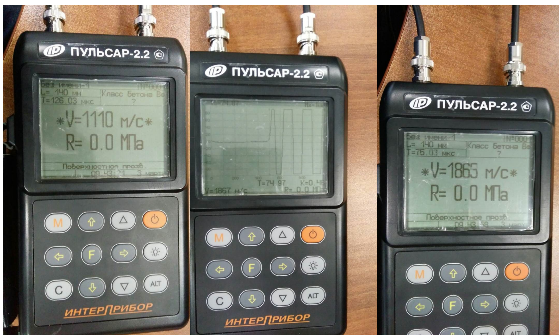
Рис. 1. Определение скорости звука в исследуемом материале для создания мягких тканей фантома
