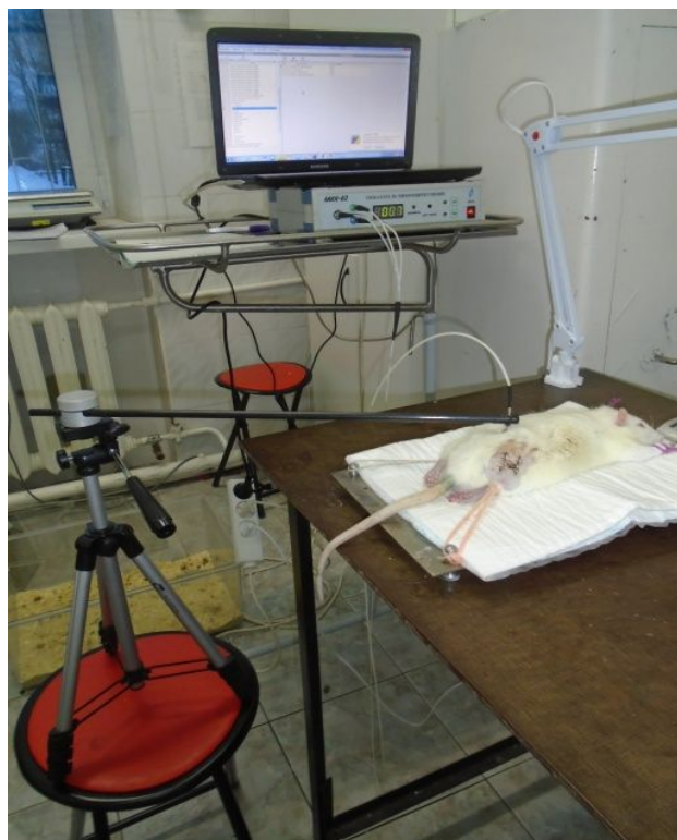
Рис. 2. ЛАКК-02 (лазерный анализатор капиллярного кровотока)
