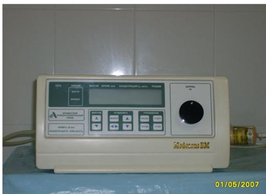
*Рис. 1. Установка для получения медицинского озона*
