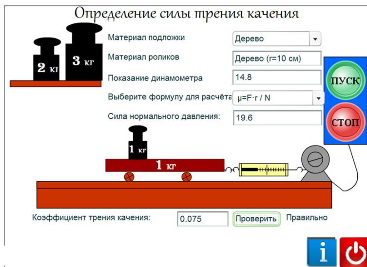
Рис. 5. Проверка правильности вычисления коэффициента трения качения
