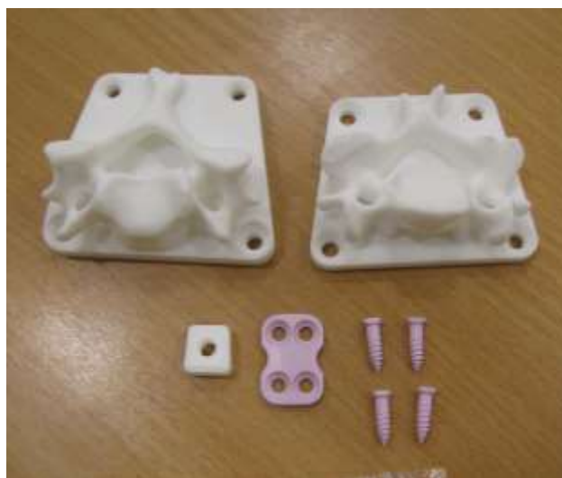
Рис.1. Фотография полноразмерных полимерных моделей C5 и C6 шейных позвонков, изготовленных методом 3D-печати
