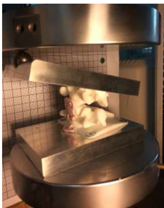
Рис. 3. Фотография системы фиксированных керамическими имплантатами полимерных позвонков, установленных в металлическую оснастку, в момент разрушения пластины на универсальном измерительном комплексе Instron 3369
