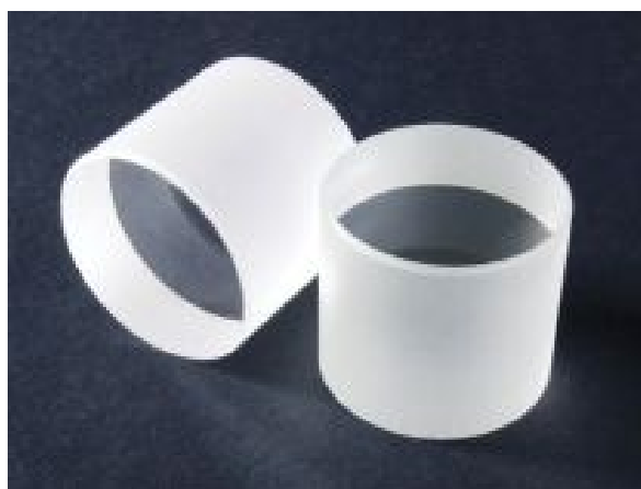
Рис. 1а. Кристалл сцинтиллятора
