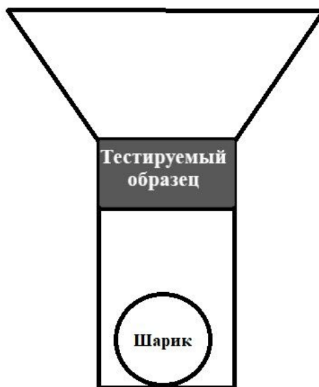
Схема кюветы коагулометра с размещенным внутри тестируемым образцом и металлическим шариком
