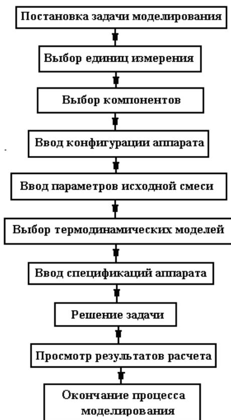
Рис. 2. Порядок моделирования в программе CHEMSEP
