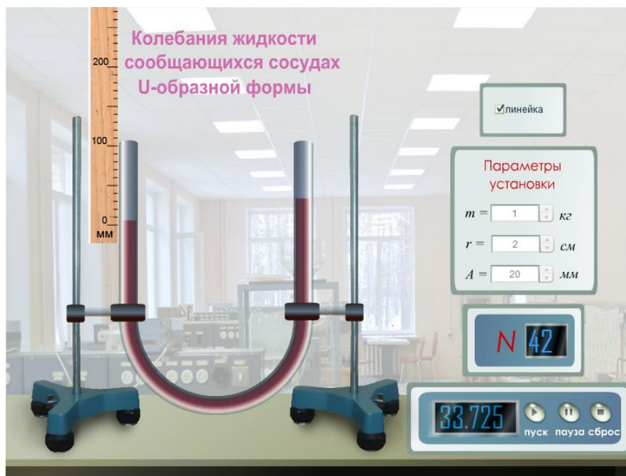
Рис. 1. Электронная установка экспериментальной задачи по изучению колебаний жидкости в сосудах U-образной формы
