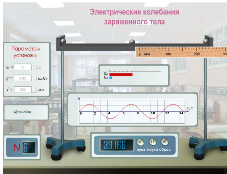
Рис. 2. Электронная установка экспериментальной задачи по изучению заряженного тела в электрическом поле
