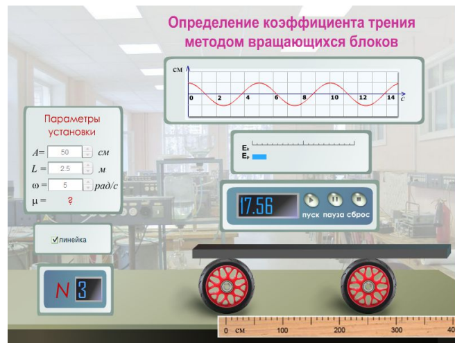
Рис. 3. Электронная установка экспериментальной задачи по определению коэффициента трения методом вращающихся блоков
