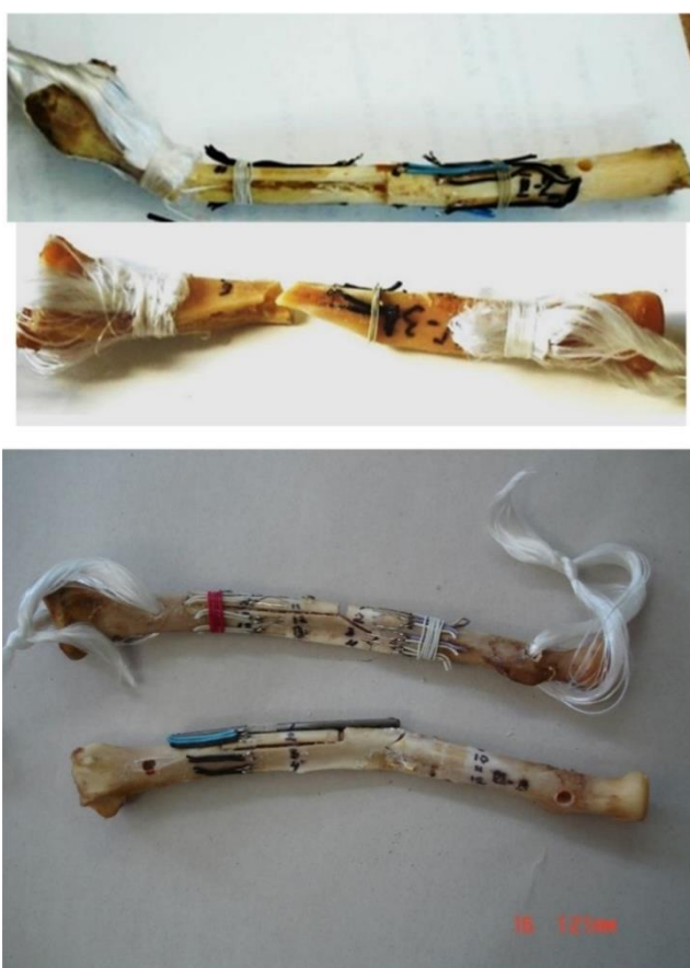
Рис. 5. Характер разрушения образцов с прямоугольным и треугольным вырезами (верхний рисунок), с прямоугольными вырезами, компенсированными кортикальными вставками с укреплением кости и без него (нижний рисунок)
