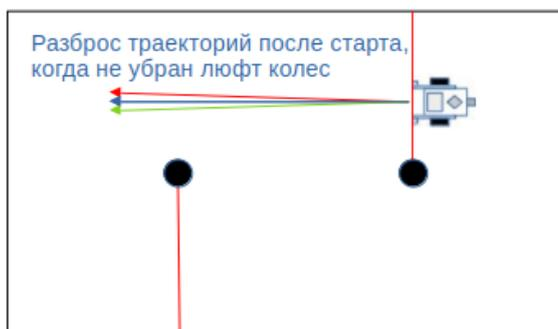
Рис. 3. Варианты траектории при разных состояниях люфта колес на старте
