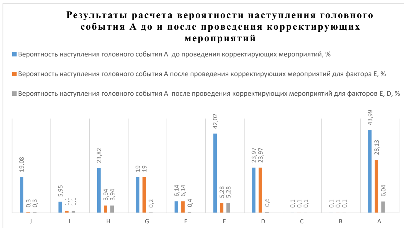
Рис. 3. Результаты расчета вероятности наступления головного события А до и после проведения корректирующих мероприятий
