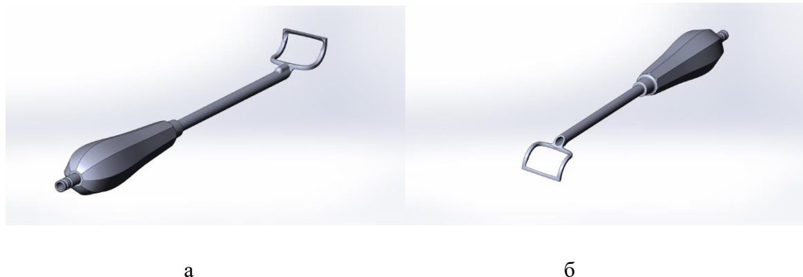
Рис. 5. Модель новой конструкции аденотома в программе SolidWorks: а – вид сверху; б – вид снизу. Примечание: составлено авторами по результатам данного исследования
